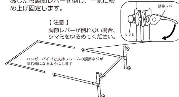
この時、ハンガーパイプ、支持フレームの調節ネジを緩めておき、高さとお中のバランスに注意して歪みのないように調節してお好みの高さ、巾で固定します。
