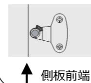
ステーブラケット取付治具の向きに合わせて取り付けて下さい。
