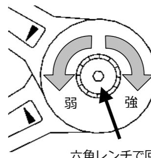
フラップステーの中央の調整部を、4mmの六角レンチで回してブレーキの強さを調整してください。
