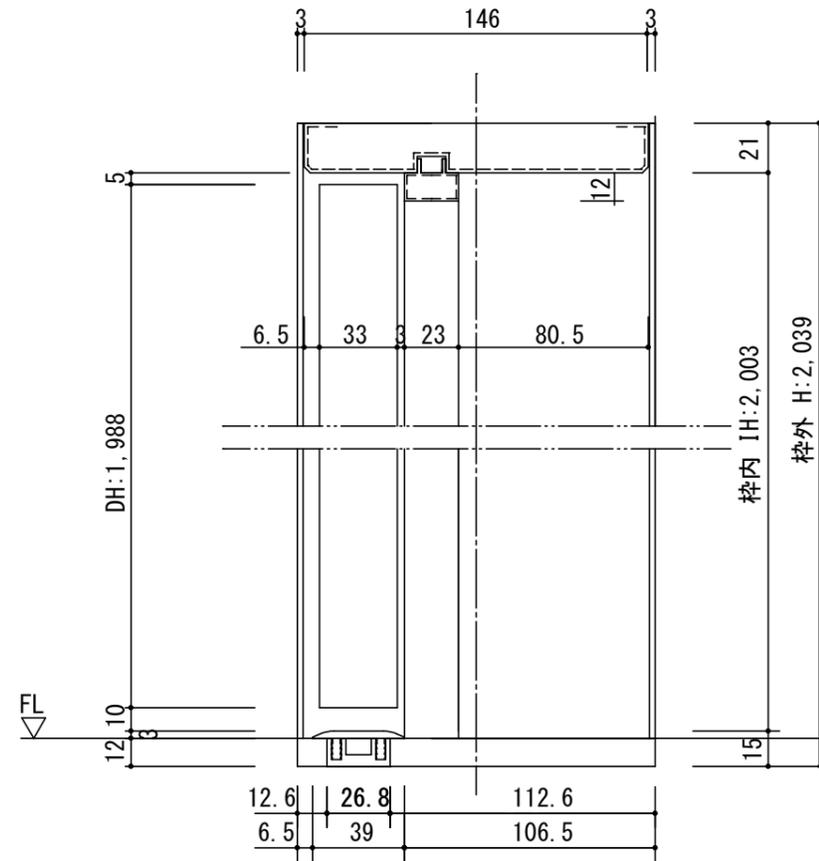
\*縦枠はH:2,043mmで納品されますので、現場の納め方により枠外H寸法が異なります。施工説明書をご確認のうえ、現場にてカットして施工をお願いします。
