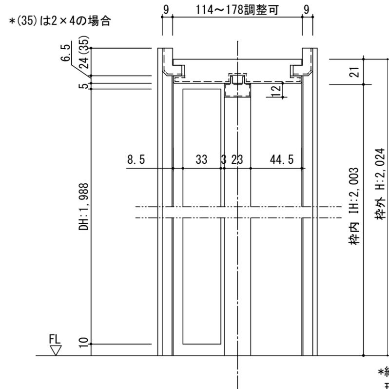
\*縦枠はH:2,043mmで納品されますので、現場の納め方により枠外H寸法が異なります。施工説明書をご確認のうえ、現場にてカットして施工をお願いします。
