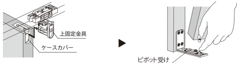
扉を折りたたんだ状態で吊り元側に寄せ、レール内の上固定金具に子扉のケースカバーをカチッと音がするまで差し込み、取り付けます。
