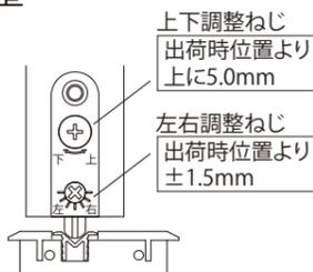
※製品出荷時の戸とVレールの隙間寸法: 3.9mm
