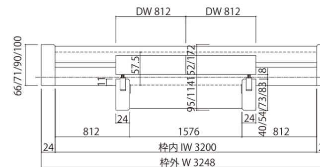
※95mm枠の場合、鴨居と縦枠のクリアランスは1mmになります。
