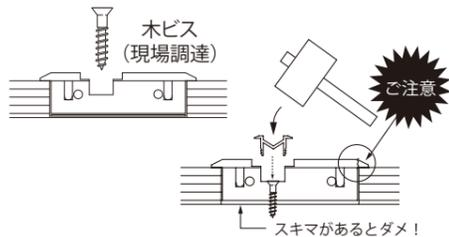
ハイブリッド敷居の場合は、下図のように厚紙または、カットベニアを必ず敷いてください。敷かずレールを叩き込むと、破損する恐れがあります。
